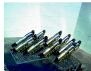
Detalle de las once antenas del VSA
